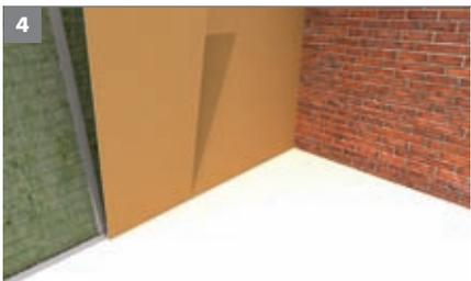
4 Fermer la cloison en posant un parement simple ou double de plaques de plâtre Knauf.
