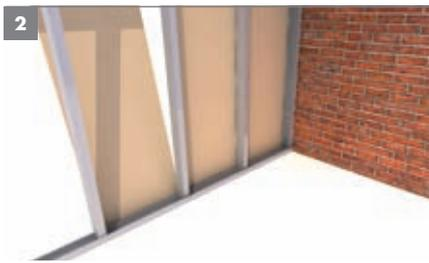
2 Sur une face de la cloison, poser un parement simple ou double de plaques de plâtre Knauf. Aligner les plaques en laissant un espace d'environ 10 mm entre le sol et le bord inférieur des plaques.
